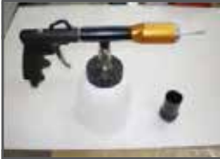
Den schwarzen Trichter losschrauben und entfernen
