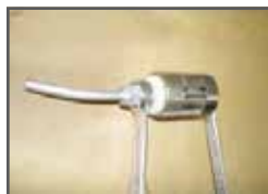
Skontroluj silnik kluczami 11 mm 7 mm w celu poluzowania rury aluminiowej
