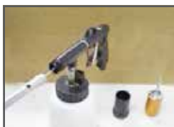
Wsuń klucz na rurę teflonową i dokręć
