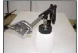
Die Schraube des Teflonschlauchs aufdrehen
