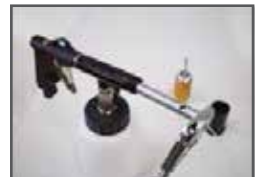
Den neuen Teflonschlauch hineinschrauben
