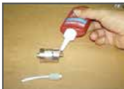
Nałóż odrobinę środka Loctite przed zamontowaniem nowej rury aluminiowej.
