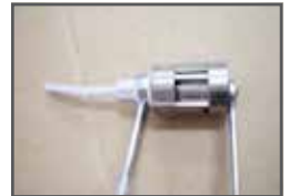
Aluschlauch mit einem 11 mm Ringschlüssel festdrehen
